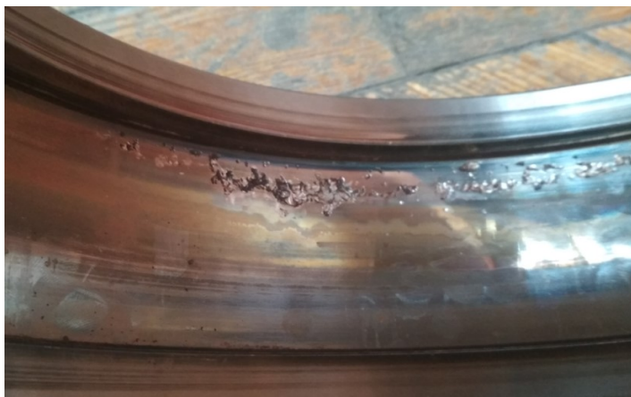
а) усталостное выкрашивание материала на внутренней поверхности наружного кольца подшипника
