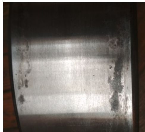
б) следы начальной стадии коррозии металла на внешней поверхности наружного кольца подшипника
